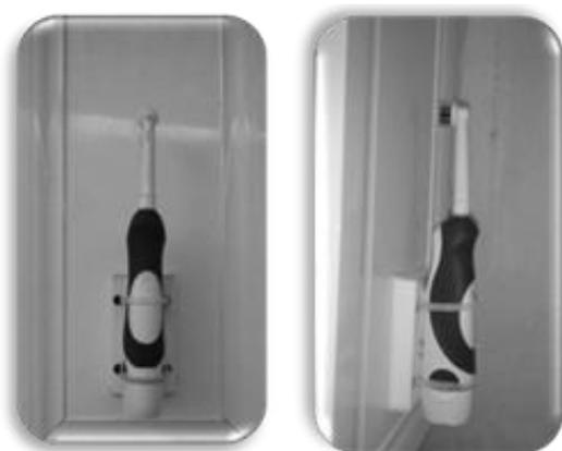
**Figura 1.** Dispositivo original que fue diseñado para el cepillado de las muestra y de esta manera poder controlar la presión ejercida durante el cepillado así como el tiempo.
