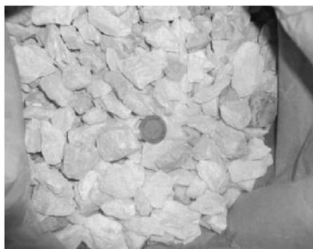
**Figura 1.** Fotografía de la wollastonita Hidalgo utilizada como materia prima antes de la molienda para la fabricación de vidrio.
